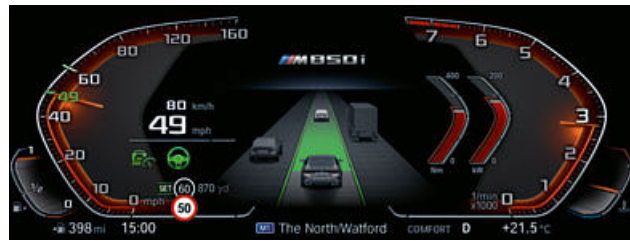
EL SPEED LIMIT ASSIST 1,* AUTOMÁTICO PERMITE AL BMW PERSONAL COPILOT ANTICIPAR LA VELOCIDAD MÁXIMA PERMITIDA Y OFRECE ADOPTARLA COMO LA VELOCIDAD DESEADA.
