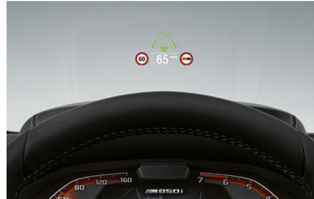
BMWヘッドアップディスプレイ。 運転に必要なさまざまな情報をドライバーの視線の先に直接映し出す。
