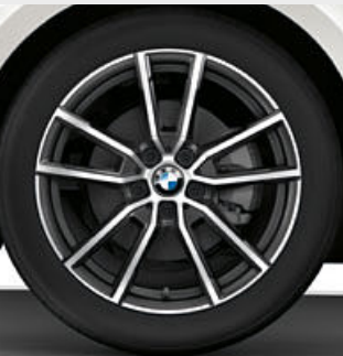
□18インチ Vスポーク・ スタイリング780 アロイ・ホイール バイ・カラー (オービット・グレー)* : 7.5J×18ホイール、 225/45R18タイヤ (ランフラット・タイヤ)
