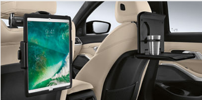
○ El soporte universal puede regularse en tamaño y fijarse a la base disponible por separado o al equipamiento Travel & Comfort opcional. Ofrece una sujeción segura para un gran número de tablets Apple o Samsung con estuche de seguridad BMW de entre 17,78 y 27,94 cm (7-11 pulgadas), puede girar 360° e incluye regulación de la inclinación.
