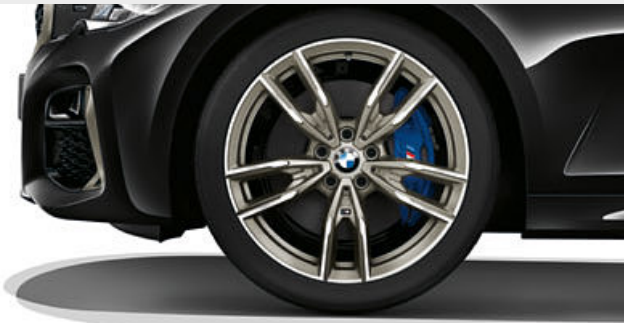
□ Llantas de aleación ligera M de 19 pulgadas con radios dobles estilo 792 M, en bicolor Ceriumgrau, con neumáticos 2,* de distintas medidas y funcionamiento en caso de avería, pulido brillante, delante 8 J x 19, neumáticos 225/40 R 19, detrás 8,5 J x 19, neumáticos 255/35 R 19.
