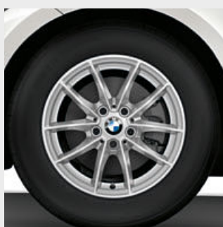
* 16インチ Vスポーク・スタイリング774 アロイ・ホイール : 6.5J × 16ホイール、 205/60R16タイヤ [ランフラット・タイヤ]
