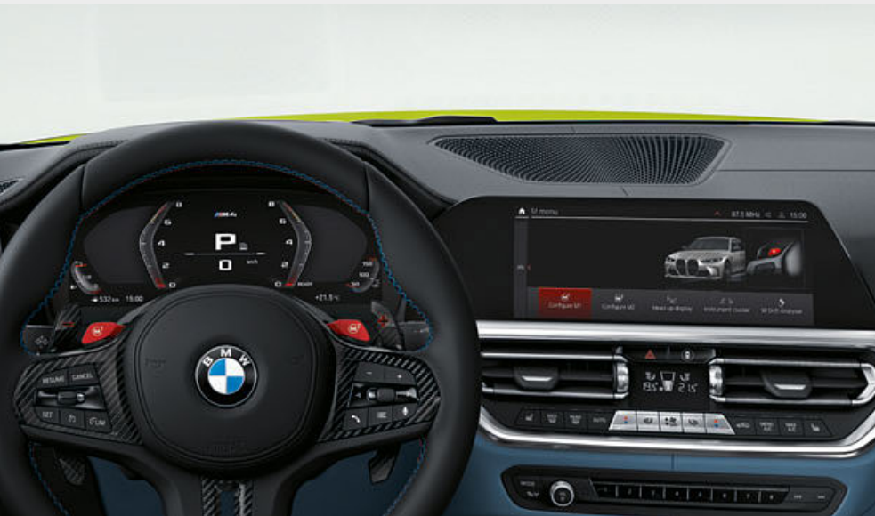
■ BMWライブ・コックピット : ナビゲーション・システムが 組み込まれたこのネットワークは、 タッチ・パネル機能付の 10.25インチのインフォメーション・ ディスプレイおよび12.3インチの デジタル表示メーター・パネルで 構成されています。 BMWオペレーティング・システム 7.0においては操作の手段を 個別に設定できるため、 タッチ・スクリーン、 iDriveコントローラーを利用して、 より直観的な操作が 可能になりました。
