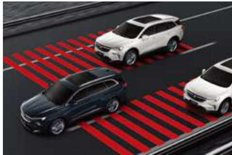
SBZA侧向盲区预警 当车辆位于后方3米的后视镜盲区内，外后视镜上的LED灯闪烁警告，避免危险发生。
