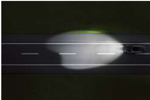
Matrix矩阵式全LED自动感应大灯 郊外模式：近光亮点100%，改善车道照明，并使对向和前方车辆不被眩光干扰。
