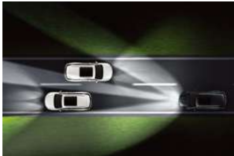
Matrix矩阵式全LED自动感应大灯 智能远光模式：大于40km/h时，自动识别跟车会车信息，控制远光光型产生矩阵暗区。
