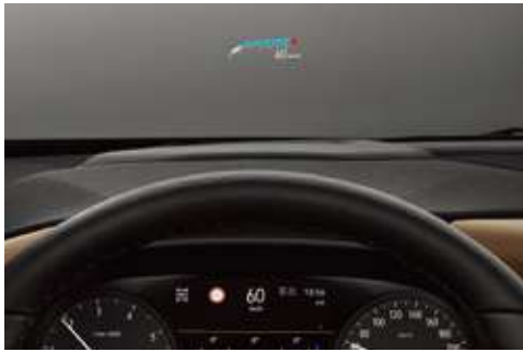
HUD平视显示系统 更清晰的显示体验使驾驶者目光无需离开前方路面，提高行车安全性。
