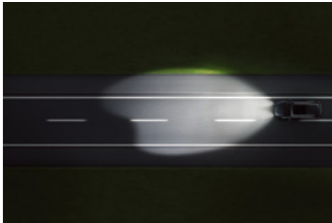
郊外模式： 近光亮点100%，改善车道照明，并使对向和前方车辆不被眩光干扰。
