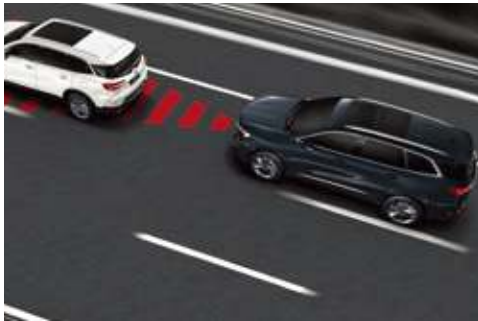
FCA前方碰撞预警及AEB碰撞自动刹车 必要时对驾驶员告警或自动刹车，避免碰撞。
