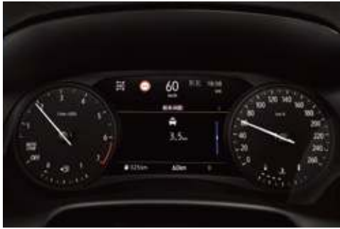
FDI前车距离提示 当车速大于40km/h时，在仪表上显示与前车的时间距离（0.5s-3s）。
