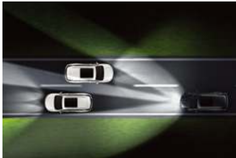
智能远光模式： 大于40km/h时，自动识别跟车会车信息，控制远光光型产生矩阵暗区。
