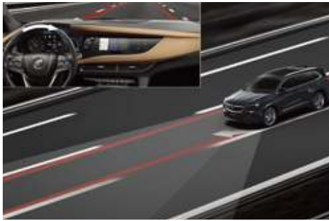
LKA车道保持 在未打转向灯或者非主动并线时，预警或自动转动方向盘将车辆调整回原行车线。
