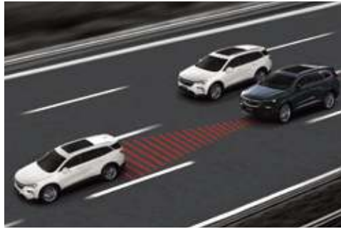
ACC自适应巡航系统 在车速大于25km/h时，通过设置可自动调整本车速度以保持与前车的预设距离。
