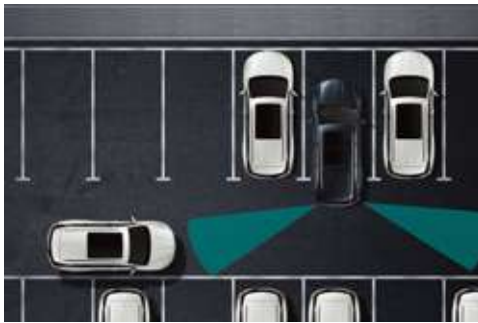
RCTA泊车预警系统 通过车体后部雷达，监测后方通过的车辆，避免在倒车时发生碰撞。
