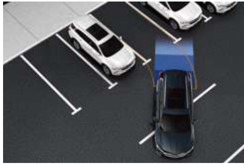
APA自动泊车系统 在30km/h以下测量合适的垂直停车位，无需操作方向盘，系统即可自动转向。
