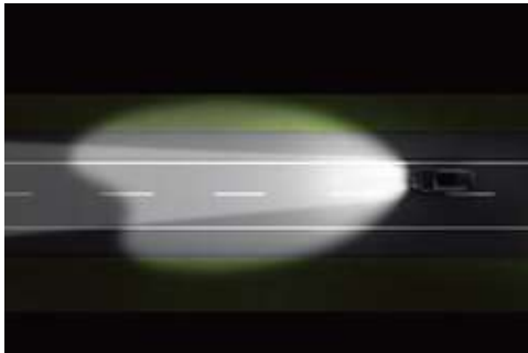
Matrix矩阵式全LED自动感应大灯 高速模式：车速高于105km/h时，光型上调0.34°，实现更好的照明效果。
