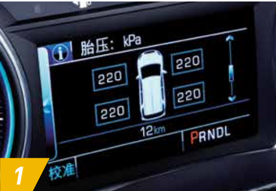
1 四轮独立式数显胎压监测 自动实时监测胎压并有数字显示,在轮胎状况异常时及时预警,保障车辆行驶安全。
