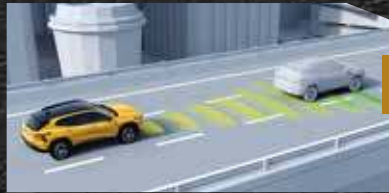
FCA前碰撞预警+AEB碰撞缓解制动
