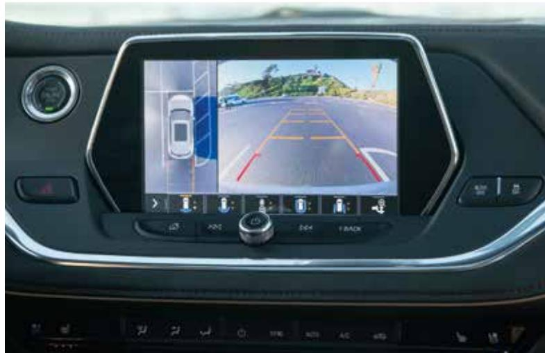
**ASISTENTE DE ESTACIONAMIENTO.** Gracias a los diferentes modos de visualización que se generan con las 4 cámaras que rodean el vehículo, se facilitan las maniobras de estacionamiento.
