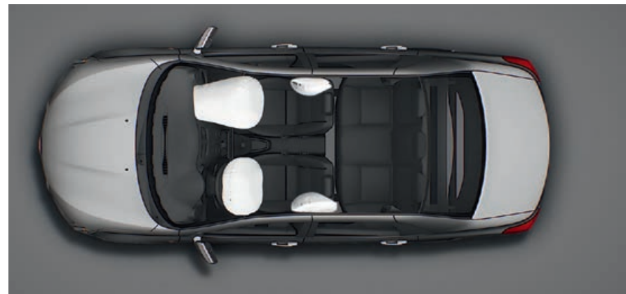
Расположение подушек безопасности
