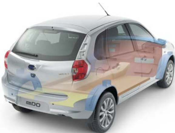
Схема шумоизоляции двигателя и салона
