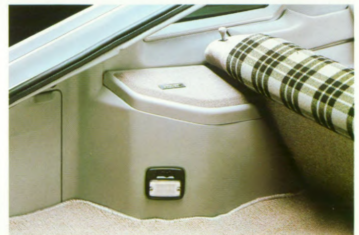
verlichting in de bagageruimte
