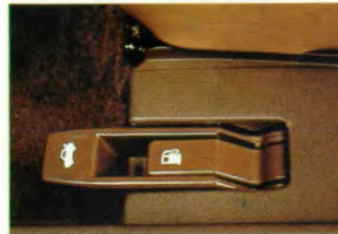
kofferdeksel en benzinetankklepje van binnenuit te openen
