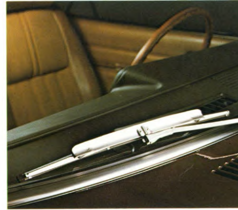
De met twee snelheden plus interval geregelde anti-lift ruitewissers zorgen voor een optimaal zicht bij slecht weer.
