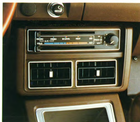
Het ventilatiesysteem van deze Datsun is heel eenvoudig in bediening en doelmatig in gebruik. De capaciteit van de kachel is uitgesproken groot, de krachtige met drie snelheden uitgeruste fan koelt het interieur zomers en brengt het 's winters snel op een behaaglijke temperatuur.
