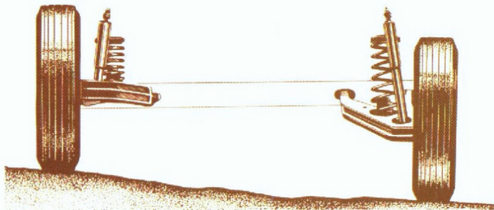
Nicht jedes Auto bietet Ihnen Einzelrad-Aufhängung an allen vier Rädern, obwohl dies Voraussetzung ist für ein absolut sicheres und beherrschtes Fahren.
