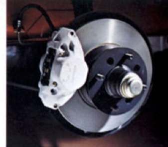
Overdimensjonerte skivebrems foran med servo.
