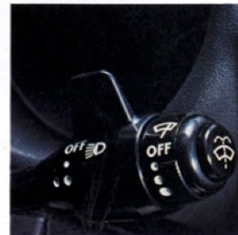
Kombinert lys- og visker/vasker automatikk på rattstammen for lettere betjening.
