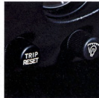
Brytere for tripteller og variabel instrumentbelysning.
