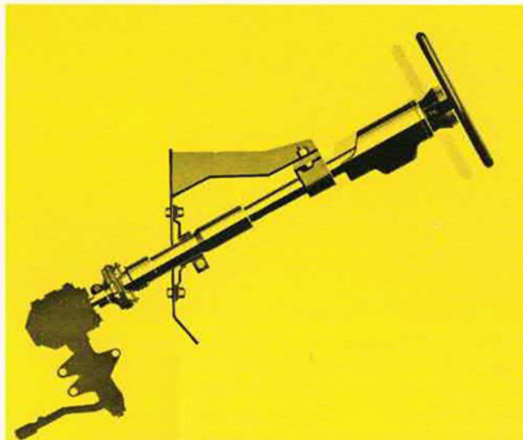
Geteilte Sicherheits-Lenksäule, die sich aufpralldämpfend zusammenschiebt
