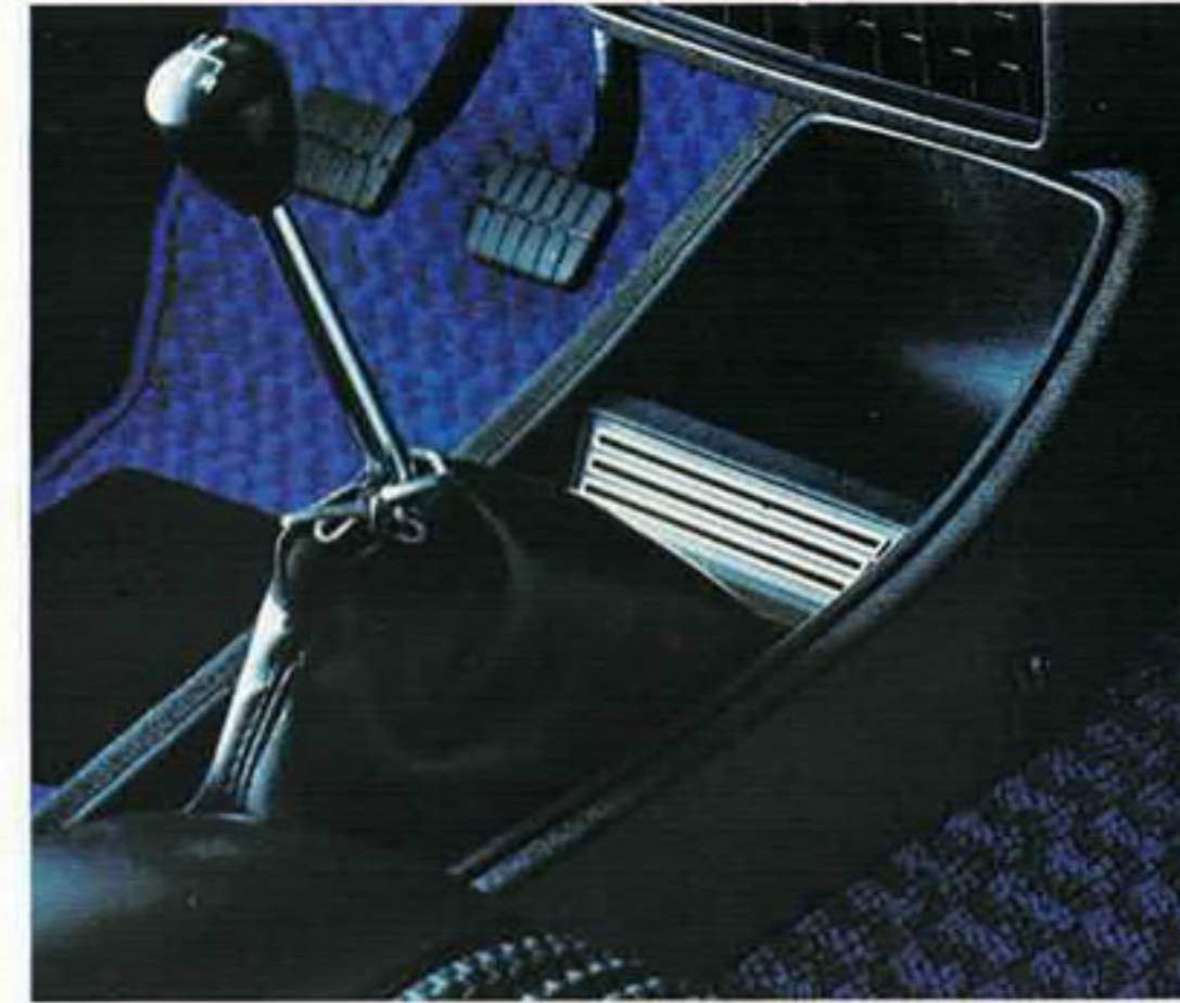
Sportliche 4-Gang-Schaltung mit kurzen Schaltwegen sowie zusätzliches Ablagefach.
