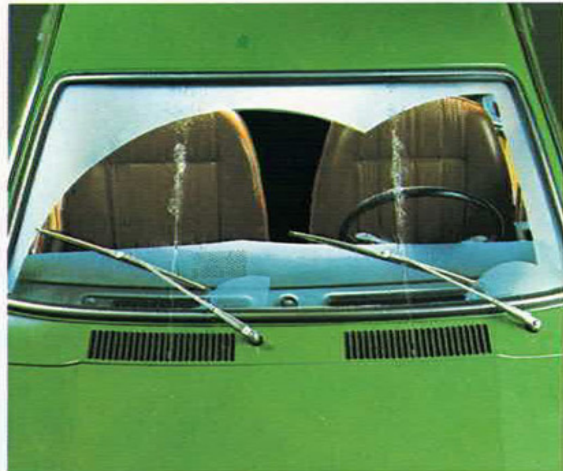
Elektrische Wisch-Waschanlage mit großem Wischfeld
