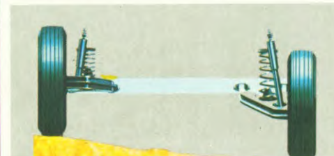
Suspension arrière indépendante avec bras oscillants, ressorts hélicoïdaux, et amortisseurs type De Carbon.
