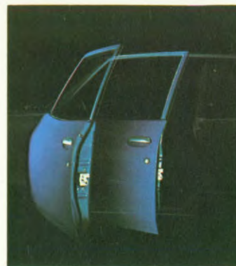
Avantage appréciable : l'ouverture des portes dispose de deux crans d'arrêt.
