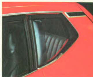
Un déflecteur latéral réduit les courants d'air et les bruits de vent.
