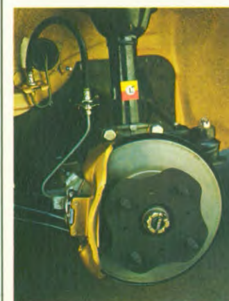
Disque de frein avant. On en remarquera les dimensions rassurantes.
