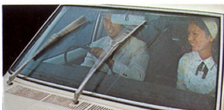
高速時にも確実に作動し、中央部分の拭き残しをなくし更に視界を広げたタンデム式ワイパー
