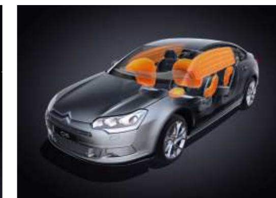
En caso de choque, son 9 los airbags que pueden desplegarse instantáneamente para proteger a los ocupantes. En la plaza del conductor: tres airbags, frontal, de rodillas y lateral izquierdo; en la plaza del pasajero: un airbag frontal y un airbag lateral derecho; en las plazas delanteras y traseras, dos airbags cortina para proteger la cabeza y, en opción, un airbag lateral para cada uno de los pasajeros laterales.
