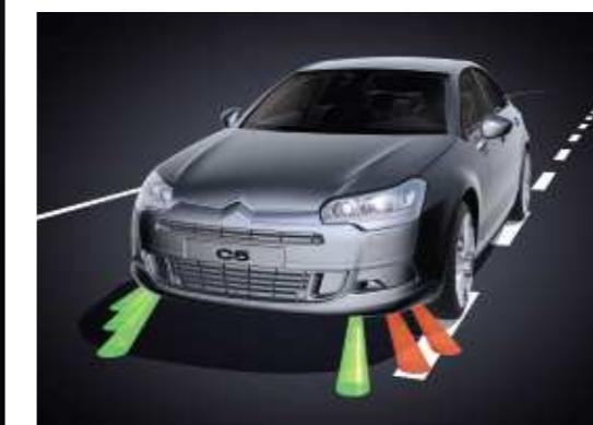
A partir de 80 km/h, el sistema de alerta de cambio involuntario de carril actúa al cruzar una línea si previamente no se ha accionado el indicador de cambio de dirección. Activando un vibrador implantado bajo su asiento, alerta al conductor para que realice la corrección de trayectoria requerida.
