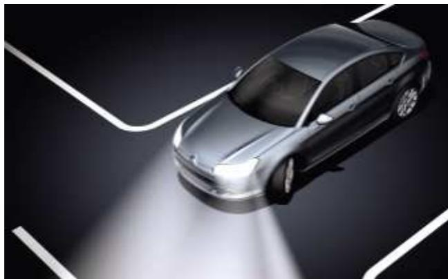
El dispositivo de medición de plaza disponible permite al conductor saber si dispone de espacio suficiente para aparcar. Activado por un mando ubicado en la plancha de a bordo y asociado con el indicador de dirección, el sistema señala al conductor el nivel de dificultad de la maniobra que tendrá que efectuar.
