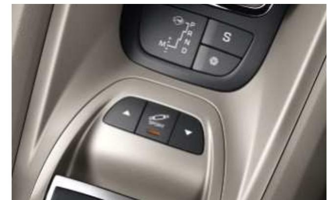
El conductor dispone igualmente de un mando de aumento/dismisión de la distancia al suelo, situado en la consola central, así como de un conmutador del modo de suspensión que le ofrece una suspensión «flexible y confortable» o un modo «sport» más rígido para aumentar la estabilidad y disfrutar de sensaciones de conducción más deportivas.
