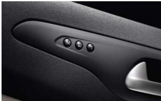
La función memorización es controlada por dos botones integrados en la moldura del panel de puerta, permitiendo que dos conductores diferentes puedan recuperar en cada instante sus propios reglajes de la posición del asiento y de los retrovisores exteriores.
