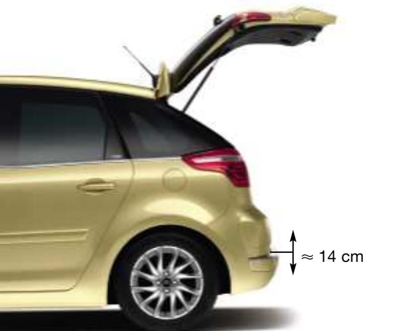
Le sospensioni pneumatiche posteriori autolivellanti offrono un ulteriore vantaggio: un comando posto all'interno del bagagliaio consente al veicolo fermo di abbassare o di sollevare di circa 7 cm la soglia di carico. Il ripristino avviene poi manualmente attraverso il comando o automaticamente appena il veicolo supera la velocità di 10 km/h.
