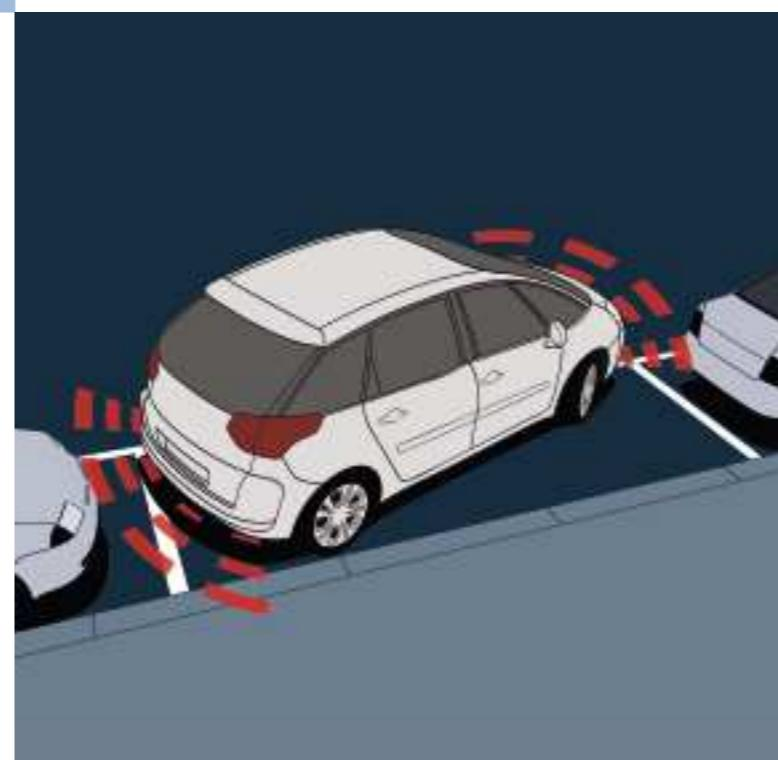
Innovazione introdotta da Citroën, l'Easy Parking System, misurando lo spazio disponibile, consente al conducente di valutare l'adeguatezza dello spazio per il parcheggio. Attivato tramite un comando posto sul volante, il dispositivo misura lo spazio libero dal lato ove viene attivato l'indicatore di direzione, mentre il veicolo si sposta a meno di 20 km/h lungo la zona prescelta. Il sistema informa immediatamente il conducente precisandogli il livello di difficoltà della manovra da effettuare.
