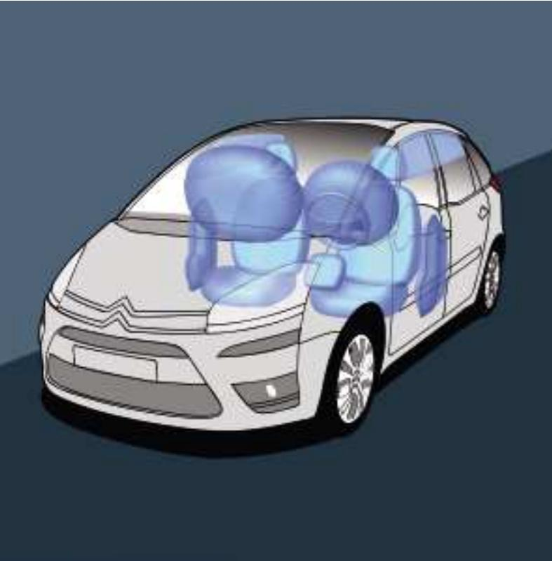
I due airbag frontali, di cui quello lato guida dalla forma ottimizzata, sono adattivi: un sistema adatta velocità e pressione del gonfiaggio alla gravità dell'urto.
