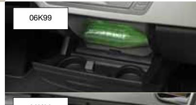
Dos grandes compartimentos se encuentran en la parte superior, derecha e izquierda, de la plancha de a bordo. Están guarnecidos de un revestimiento anti-deslizante, disponen de iluminación interior y una trampilla de apertura amortiguada.
