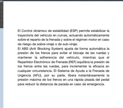
El Control dinámico de estabilidad (ESP) permite estabilizar la trayectoria del vehículo en curvas, actuando automáticamente sobre el reparto de la frenada y sobre el régimen motor en caso de riesgo de sobre-viraje o de sub-viraje.
