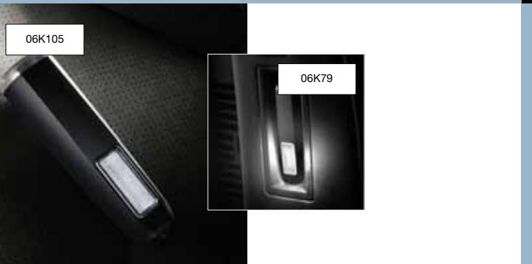
Las versiones equipadas con bandeja en el respaldo de los asientos delanteros pueden disponer de una lámpara de lectura. El alumbrado automático del maletero a través de una lámpara móvil que puede estar liberada de su soporte de carga y que se convierte en una verdadera linterna, con una autonomía de aproximadamente 40 minutos. Fácil de encontrar, siempre cargada y siempre a plena potencia.
