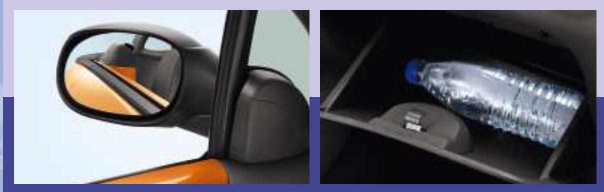
**Perfetta visibilità posteriore.** I retrovisori esterni, a regolazione elettrica, si posizionano quasi al millimetro grazie al pulsante di comando inserito a portata di mano del guidatore.
