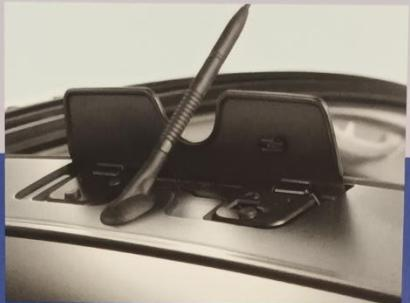
■ En configuración «techo abierto», el deflector de techo se despliega para neutralizar el ruido del aire desagradable, provocado por la velocidad cuando las lunas están cerradas.
