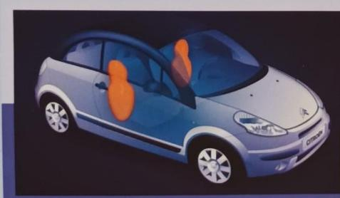
■ **Seguridad multiplicada.** El C3 Pluriel dispone de 4 airbags de protección de las plazas delanteras: dos airbags frontales y dos laterales específicos, con doble bolsa, que protegen a la vez la cabeza y el tórax.
