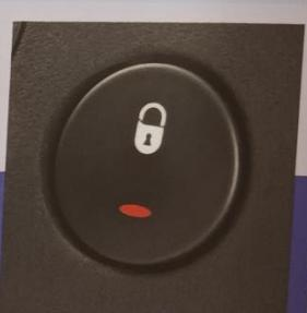
■ **Cierre centralizado.** Bloquear o desbloquear eléctricamente las puertas, la luneta y el portón trasero (se cierran automáticamente al pasar de 10 km/h).
