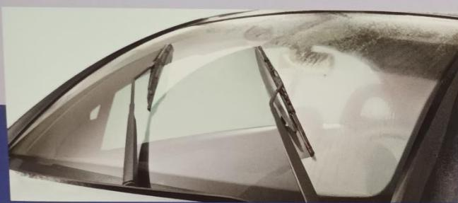
■ **Lluvia detectada.** Gracias a la función captador de lluvia, los limpiaparabrisas se activan ellos mismos a la primera gota de agua, adaptando su ritmo, de forma automática, a la intensidad de la lluvia.
