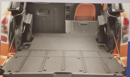
■ **Amplia superficie trasera.** Los respaldos de la banqueta trasera son fraccionables y abatibles independientemente uno del otro. En configuración «Pick-up», con el portón trasero abierto, se facilita el acceso de la carga al maletero, el C3 Pluriel ofrece una plataforma de carga totalmente plana, de 175 mm de longitud, capaz de soportar hasta 100 Kg.
