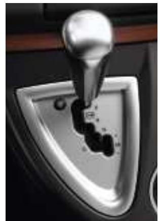
Il cambio automatico auto-adattativo con comando sequenziale\* analizza continuamente tutti i parametri (tipo di fondo stradale, stile di guida, intensità di frenata...) per selezionare il rapporto più adatto. Per uno stile di guida più dinamico si può sempre decidere di passare in modalità manuale sequenziale.
