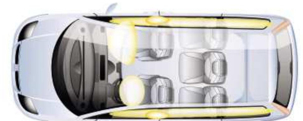
Di serie su tutte le versioni di Citroën C8, gli airbag conducente (60 litri) e passeggero anteriore (100 litri) sono studiati in modo da adattare la pressione all'intensità dell'urto. La protezione del torace è assicurata dagli airbag laterali installati nei sedili anteriori. Di serie anche gli airbag a tendina da 48 litri integrati nel padiglione del veicolo per proteggere la testa dei passeggeri dei sedili laterali sulle tre file.
