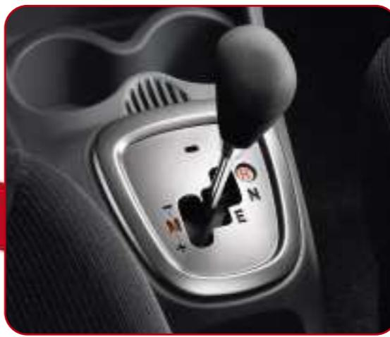
Cambio Manuale Pilotato 5 rapporti (CMP-5) disponibile sul motore benzina, per il massimo confort nella guida in città.
