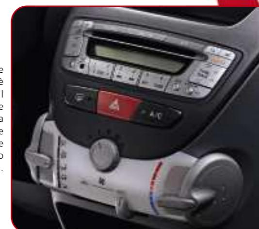
I comandi del climatizzatore di forma bombata in materiale translucido, retroilluminati di arancione quando i fari sono accesi, si integrano con il quadro strumenti e il sistema audio.
