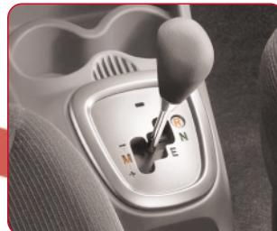
Caja de cambios SensoDrive con modo automático y secuencial, propuesta para las versiones gasolina, para moverse en ciudad con total confort (próxima comercialización).
