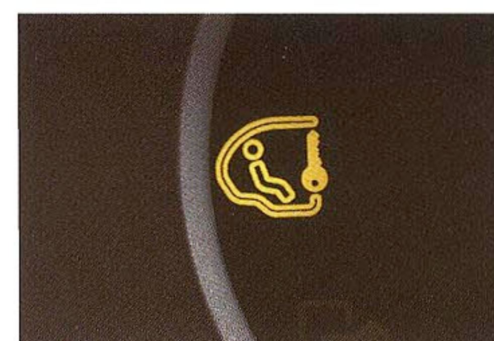
メーターパネル内の表示により、運転席からも確認できるインジケータ付チャイルドブレーク
