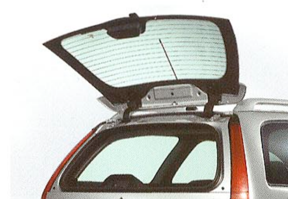
狭いスペースでも荷物の出し入れを容易にする独立式リアハッチウインドー(C5プレーク)
