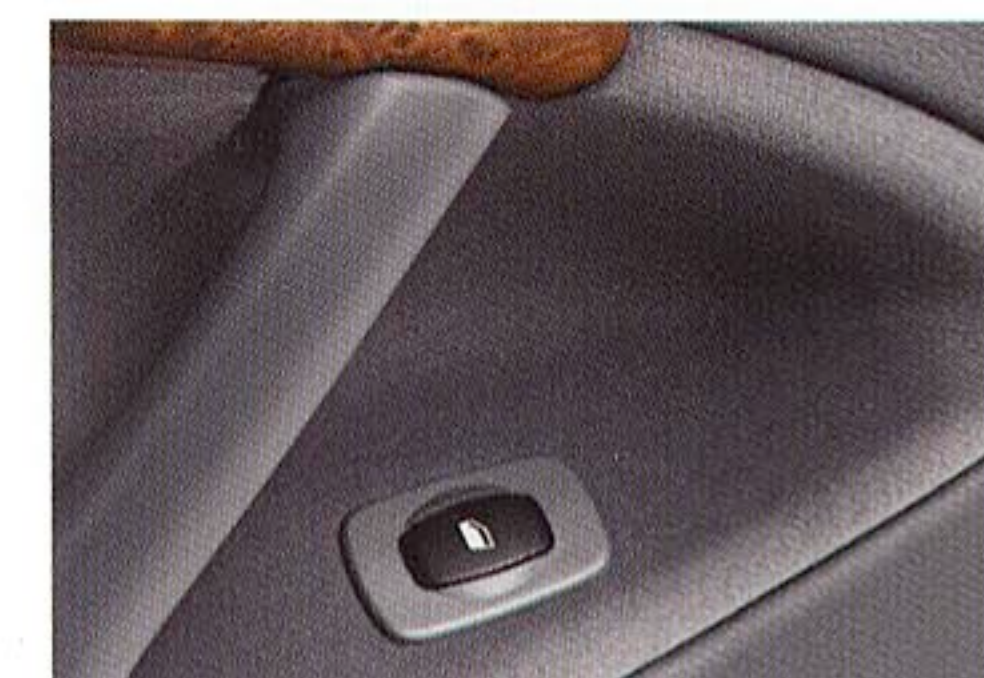
フロント/リア全席に装備されたアンチピンチ機構付ワンタッチパワーウインドー
