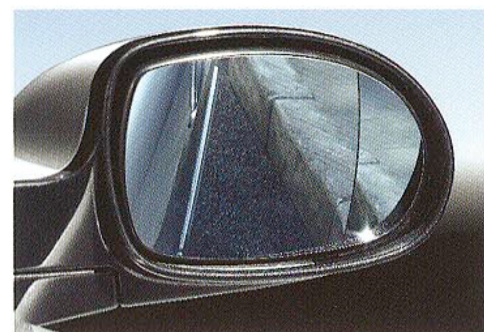
リバースギアで助手席側のミラーが下向きになり後方下部の視界を確保するオートマチックバックモードドアミラー
