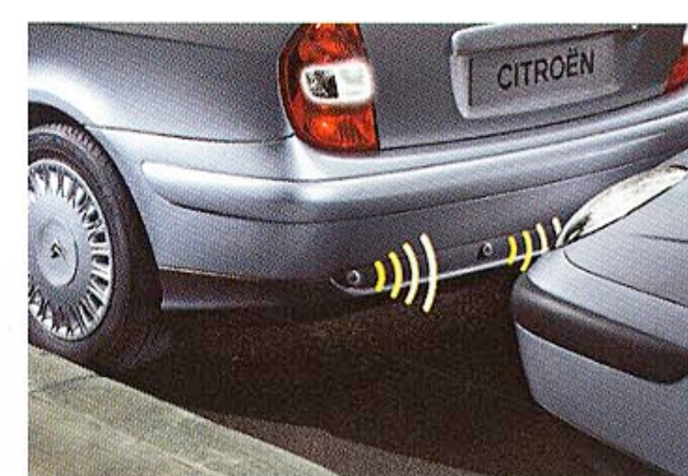
車庫入れなどの後退の際、後方障害物への接近を感知し安全性を高めるバックソナー
