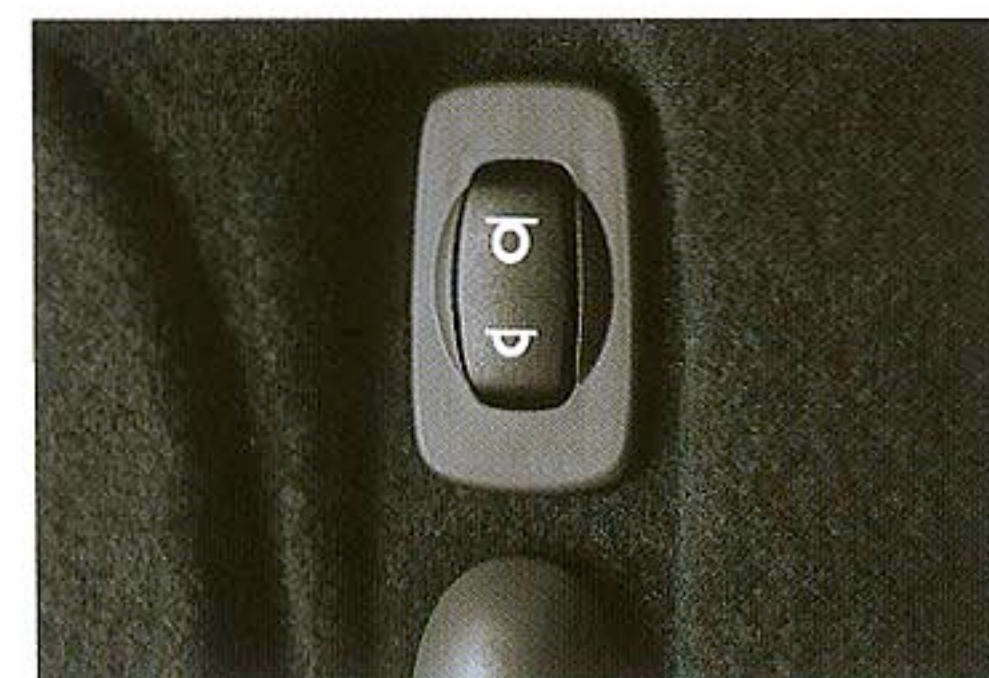
重い荷物の積み下ろし時などに便利な、車高調整をラゲジルームから操作できるハイトコントロールスイッチ(C5 プレーク)
