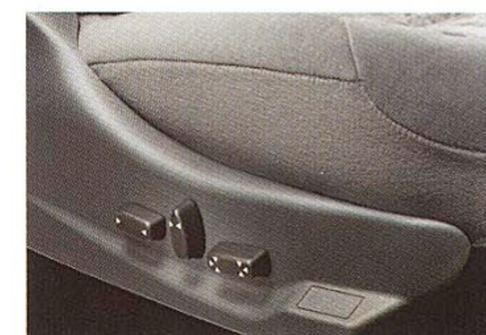
簡単なスイッチ操作で最適なシートポジションに調整できるフロントパワーシート(V6エクスクループ)
