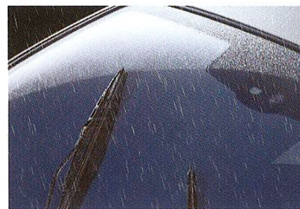
雨量に応じてワイパースピードを自動調整する雨滴感知式オートワイパー
