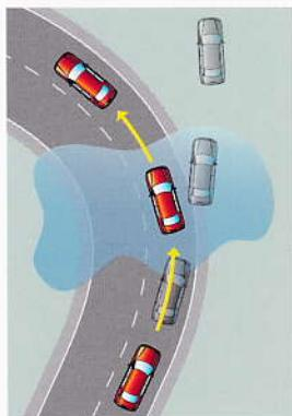
Gefahrensituationen zu vermeiden, indem es durch gezieltes Abbremsen einzelner Räder eingreift. Der Bremsassistent (BAS) stellt bei Bedarf zusammen mit dem Antiblockiersystem (ABS) die volle Bremsleistung zur Verfügung.
