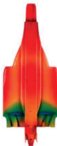
Fondo piatto F1: andamento dei coefficienti di pressione The F1's flat underbody: contours of pressure coefficient
