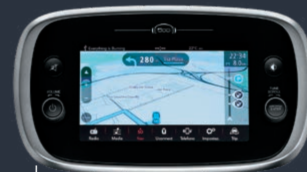
Uconnect™ Navigationssystem mit Europakarte und 7"-HD-Touchscreen, Bluetooth®-Freisprecheinrichtung, USB, DAB+ und 6 Lautsprechern
