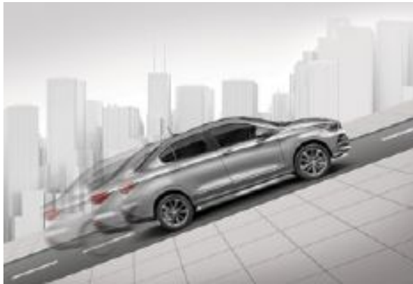
Hill Holder : ayuda en los arranques en subida y en descenso, manteniendo el freno accionado para que el motor tenga fuerza para arranzar. (equipamiento disponible según versión)
