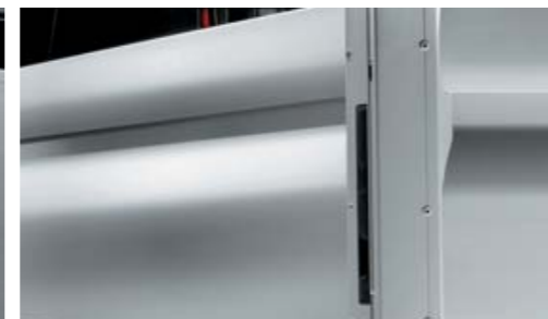
Cavité pour crochets de retenue de chargement
