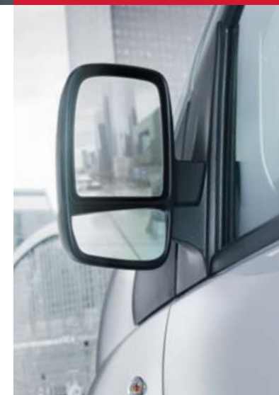
Doppelparabol-Außenrückspiegel zur Verbesserung der Sicht nach hinten. Die Öffnung bzw. Schließung der Rückspiegel kann elektrisch gesteuert werden.
