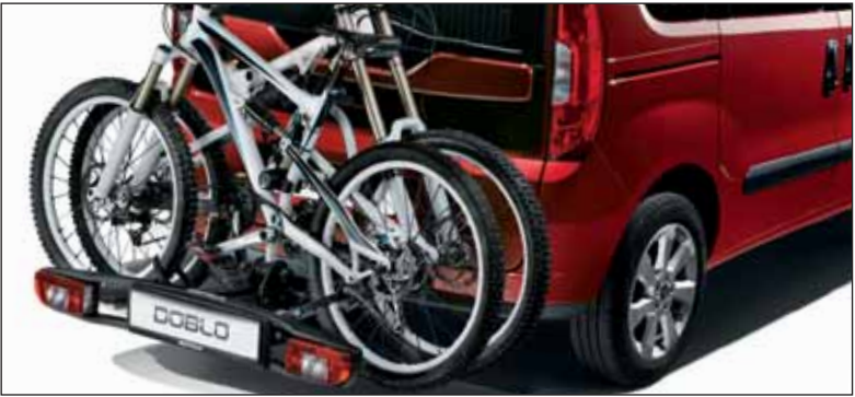
Portabicicletas en el gancho de remolque, que puede colocarse en dos alturas
