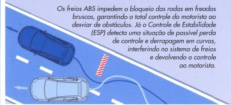
Os freios ABS impedem o bloqueio das rodas em freadas bruscas, garantindo o total controle do motorista ao desviar de obstáculos. Já o Controle de Estabilidade (ESP) detecta uma situação de possível perda de controle e derrapagem em curvas, interferindo no sistema de freios e devolvendo o controle ao motorista.
