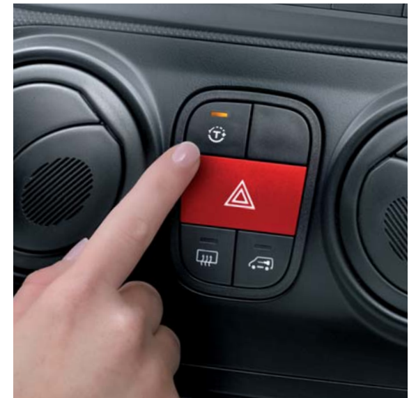
Traction+ optimiert den Antrieb bei langsamer Beschleunigung.
