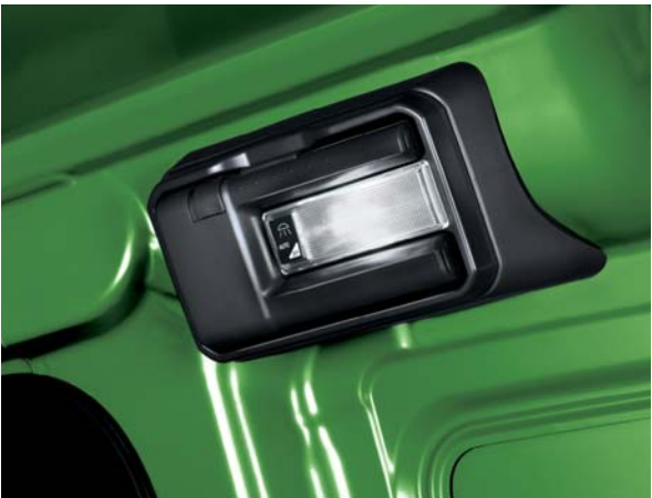
Laderaum mit abnehmbarer Innenleuchte, die als Taschenlampe verwendet werden kann.
