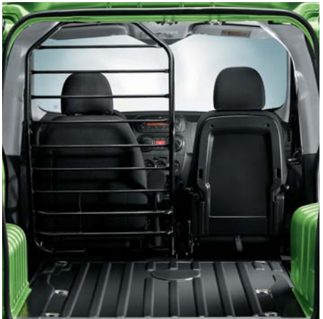
Leiterförmige Stahlrohrkonstruktion zum Schutz des Fahrers vor der Ladung
