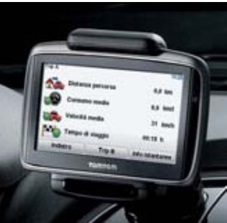
■ Pantalla de ordenador de a bordo con información sobre el recorrido para encontrar el trayecto más rápido y calcular el tiempo de llegada.
