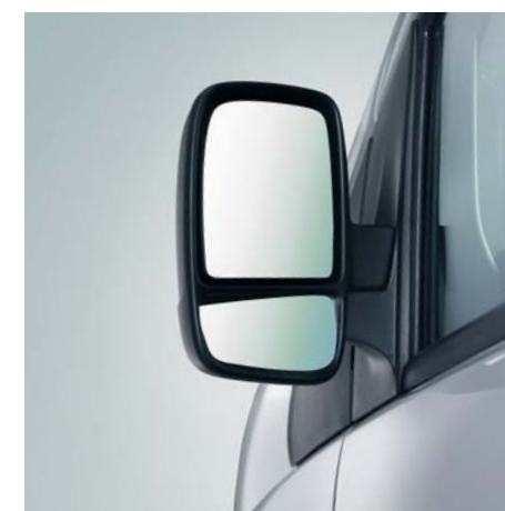
Specchietti retrovisori a doppia parabola, per migliorare la visibilità posteriore. L'apertura e la chiusura degli specchietti può essere comandata elettricamente.
