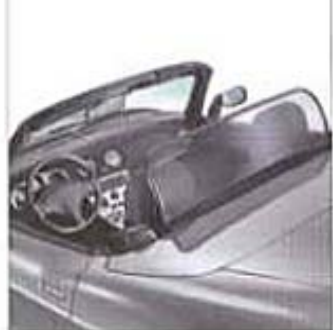
Saute-vent, disponible en option, reduisant les tourbillons d'air dans l'habitacle.
