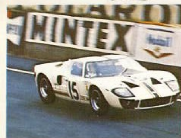
Ford GT 40: 4727 cm 3 Ford V 8, 5 Gänge, Chassis aus Alu-Bleichen in Schalenbauweise. Rennwagenaufhängung mit Gabeln und Schräglenkern und außen montierten Schraubenfeder-Stoßdämpfer-Einheiten. Motor mit 365 bis 385 PS in der Mitte des Chassis.
