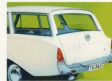
Taunus Turniers store bagdør (i Danmark lagres kun med tophængslet dør – den viste bundhængslede type hjemtages på bestilling) måler 110 x 670 mm.
