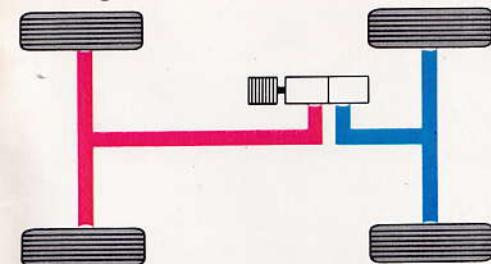
bremsen an den Hinterrädern. Trommelbremsen übertragen die Kraft der (Feststell-) Handbremse auf die Hinterräder.
