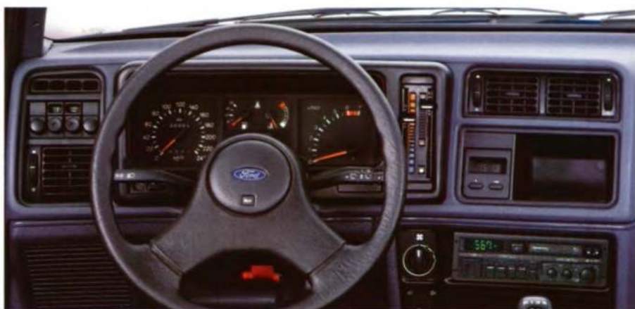
Instrumentenpaneel van de Sierra GL, met regelbare verlichting en toerenteller; Radio als extra.
