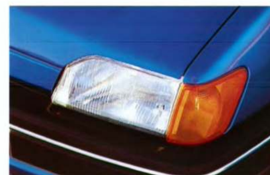
Geïntegreerde parkeerlichten en richtingaanwijzers in de koplampen.
