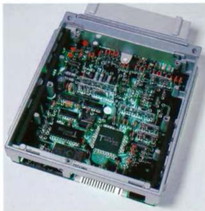
Een blik in het inwendige van de EEC IV elektronische geleenheid.
