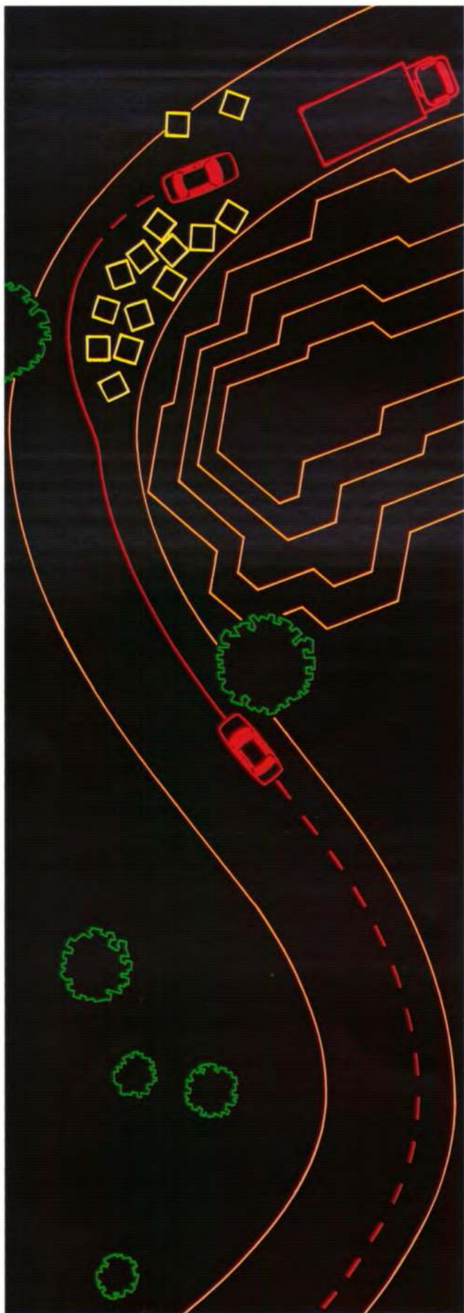
Deze tekening geeft aan hoe ABS een slip kan voorkomen onder onvoorziene remomstandigheden.
