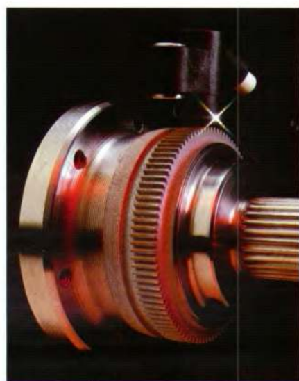
Het anti-blokkeer remsysteem werkt met elektromagnetische sensoren die een dreigende wielblokkering registreren.
