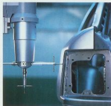
Computergesteuerter Meßkopf – Präzision durch Detailvermessung im Karosseriebereich.
