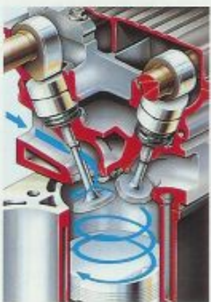
Speziell geformter Brennraum und Einlaßkanäle für besonders intensive Gemischverwirbelung.
